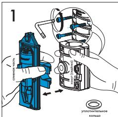
2. Разобрать хомут (седёлку), открутив шесть винтов шестигранником (5 мм), по направлению против часовой стрелки. Выбрать место установки на трубе ПНД ниже глубины промерзания, но не глубже 5 метров от уровня земли.
