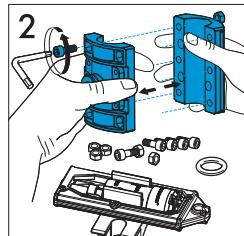
3. Установить хомут (седёлку) на место, уплотнив кольцом и стянув шестью болтами и гайками, шестигранником (5 мм) по часовой стрелке. Убедиться, что в месте соединения хомута со сливной частью нет посторонних частиц.
